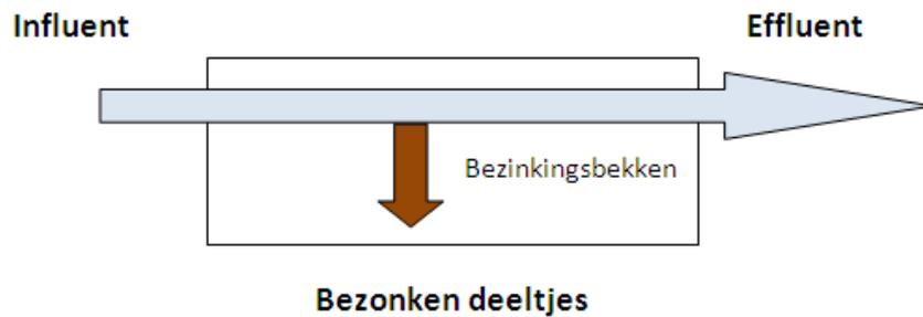
Bezinking vindt plaats in bezinkingsbekkens waar het water langzaam doorheen stroomt. Een bezinkingsbekken kan gezien worden als een open reservoir.
